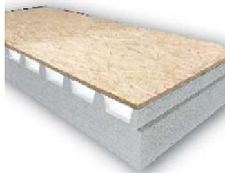
Pannello isolante ventilato in polistirene espanso sinterizzato bianco da taglio a singola ventilazione per sistemi di isolamento termico secondo EN 13163, accoppiato con pannello OSB sp.12 mm, marcato CE.
