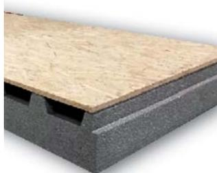
Pannello isolante ventilato in polistirene espanso sinterizzato con grafite da taglio a singola ventilazione per sistemi di isolamento termico secondo EN 13163, accoppiato con pannello OSB sp.12 mm, marcato CE.
